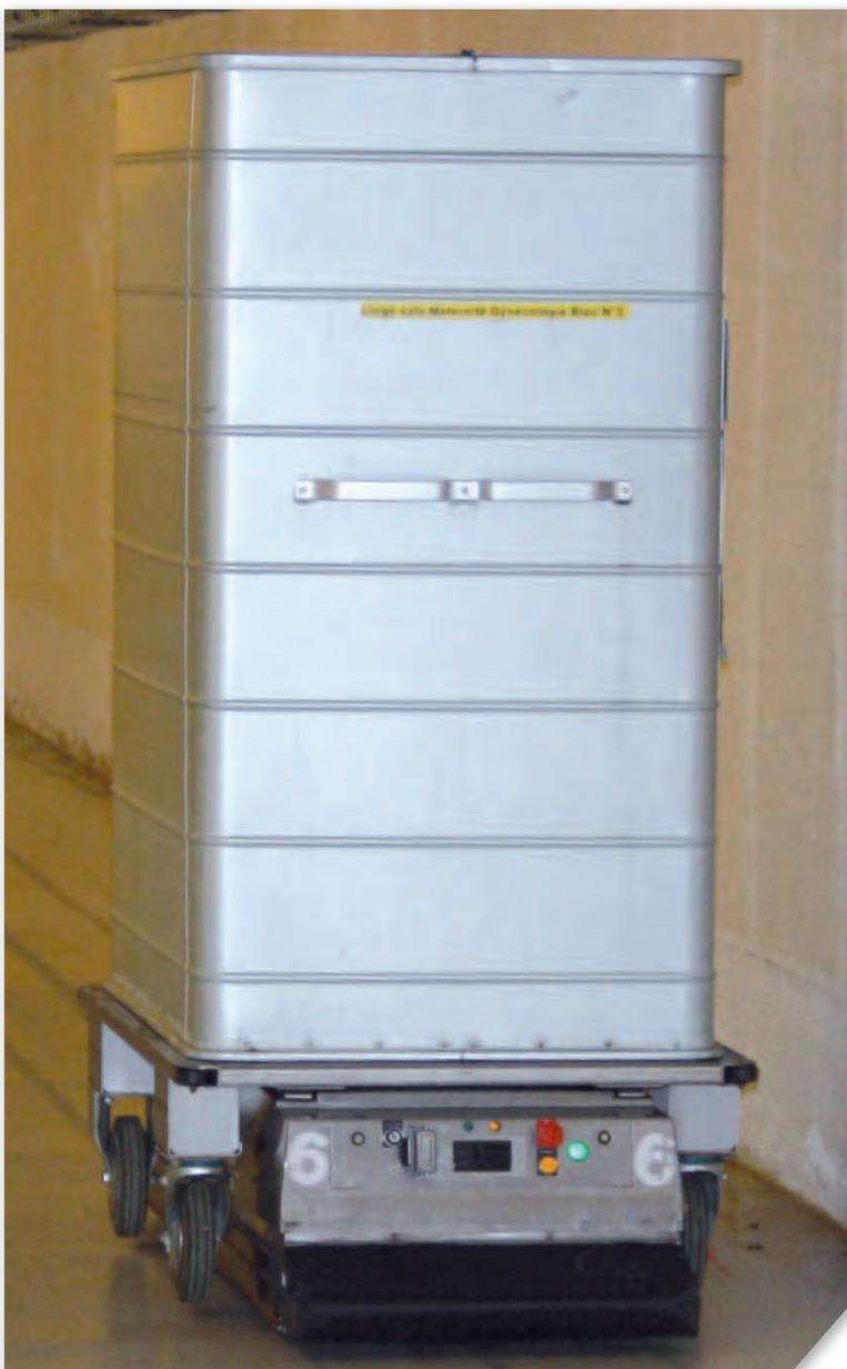
Autonomes et fonctionnant sur batterie, les véhicules autoguidés assurent le transport des chariots selon des chemins virtuels préprogrammés, en différents points de l'hôpital. Un système de supervision des véhicules assure la gestion du trafic et gère les séquences d'approvisionnement et de désapprovisionnement des services. Il permet également de suivre en temps réel les mouvements des « tortues ».
